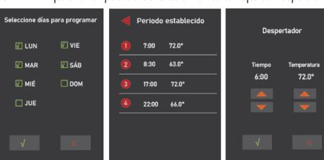
Para programar un horario, seleccione los días que desea programar, elija el periodo y, a continuación, ajuste la hora de inicio y la temperatura deseadas para el periodo la hora de inicio y la temperatura deseadas para el periodo. Repita estos pasos hasta completar el programa.
