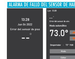
Si el termostato no se restablece a los valores normales después de un ciclo de alimentación (apagar y encender el termostato), significa que el sensor ha fallado y debe ponerse en contacto con el instalador o electricista instalador o electricista.
